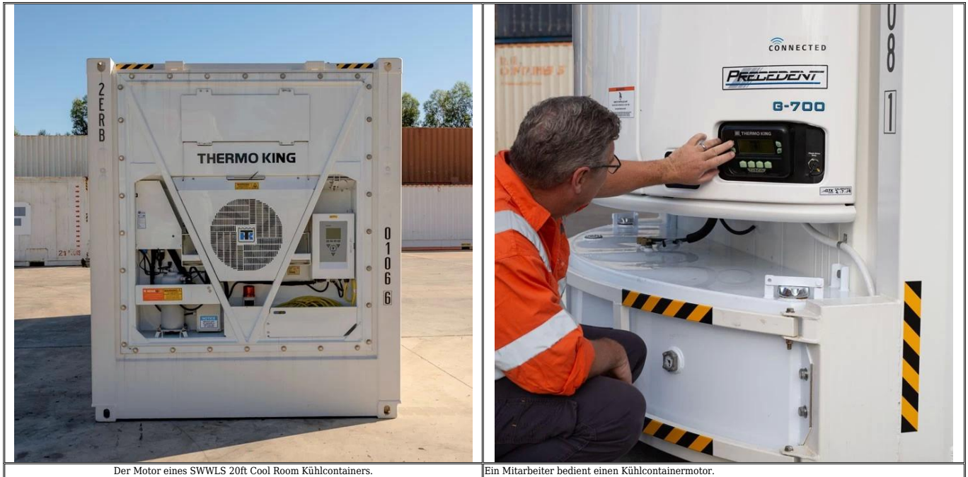
Der Motor eines SWWLS 20ft Cool Room Kühlcontainers.
