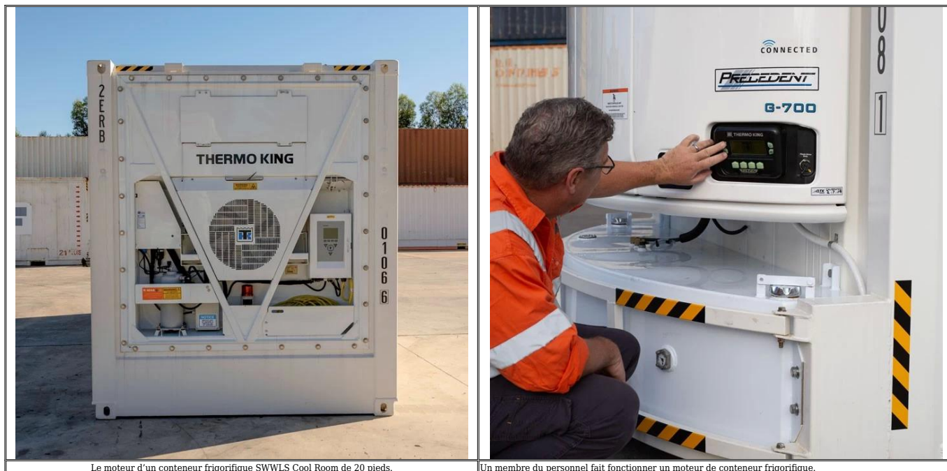
Le moteur d'un conteneur frigorifique SWWLS Cool Room de 20 pieds.
